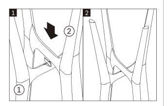
MAKE SURE THE METAL PLATE GOES INTO THE GROOVES ON THE LEG (2)
